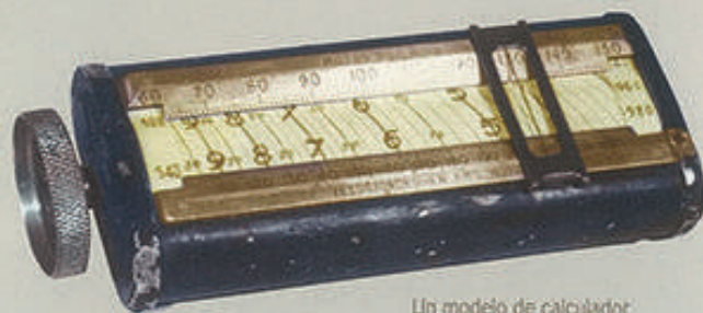
Un modelo de calculador de vuelo inventado por Carlos Haya. Foto: R. de MADRAGA/H. Haya.
